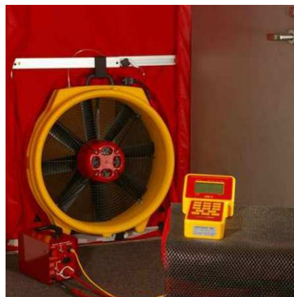
Retrotec 3000SR blowerdoor
